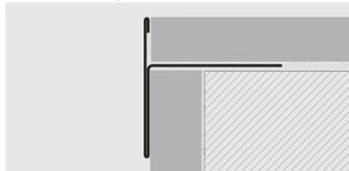
**PROTERMSTEP ACC** è un profilo in acciaio inox AISI 304/1.4301-V2A lucido costituito da una aletta traforata che ne garantisce una perfetta presa con l'adesivo impiegato e da una parte a vista verticale liscia. Il profilo può essere utilizzato anche capovolto; ogni singolo profilo è quindi idoneo per due differenti spessori di piastrina. **PROTERMSTEP ACC** in acciaio lucido è idoneo per qualsiasi tipo di scala con rivestimento in ceramica, cotto, legno e pietre naturali.
