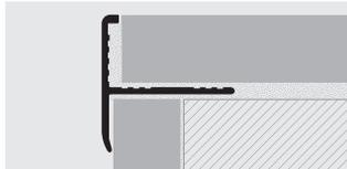
**PROTERMSTEP ALL** è un profilo in alluminio costituito da una aletta traforata che ne garantisce una perfetta presa con l'adesivo impiegato e da una parte a vista verticale liscia. Il profilo può essere utilizzato anche capovolto; ogni singolo profilo è quindi idoneo per due differenti spessori di piastrina. **PROTERMSTEP ALL** in alluminio naturale e anodizzato è idoneo per qualsiasi tipo di scala interna con rivestimento in ceramica, cotto, legno e pietre naturali.
